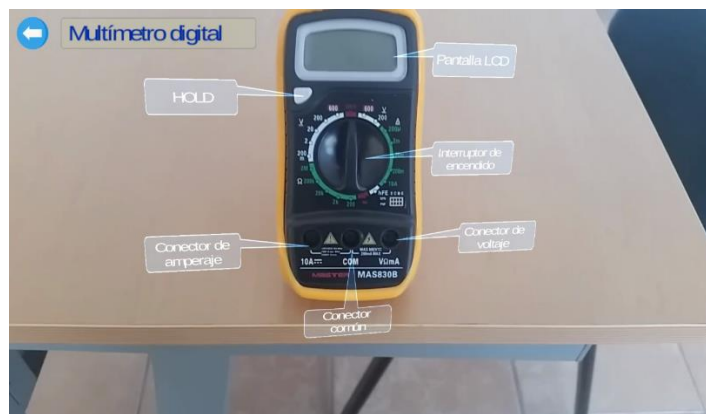
Figura 5.14. Ejemplo de descripción de componentes de un multímetro digital.
