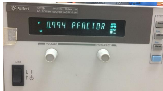
Figura 5.3 Fuente y analizador de armónicos.
