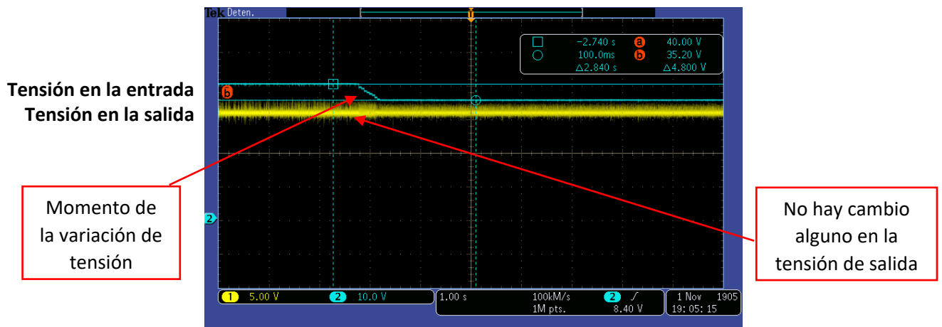
Figura 90. Prueba dinámica al convertidor: variación -14% en la tensión de entrada.
