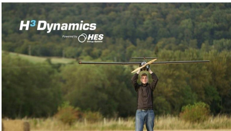
Figura 4. Drone de ala fija fabricado por H3 Dynamics con autonomía de 10 horas [5].
