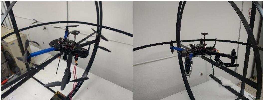
Figura 20. Drone DJI X8+ montado banco de pruebas en laboratorio de CENIDET.
