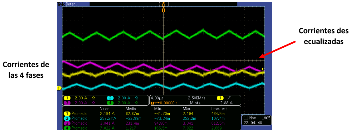
Figura 81. Corrientes por fase del convertidor en lazo abierto, corrientes des-equalizadas.
