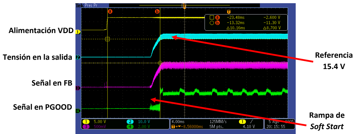
Figura 85. Señales de arranque del circuito integrado ISL6458 obtenidas experimentalmente.
