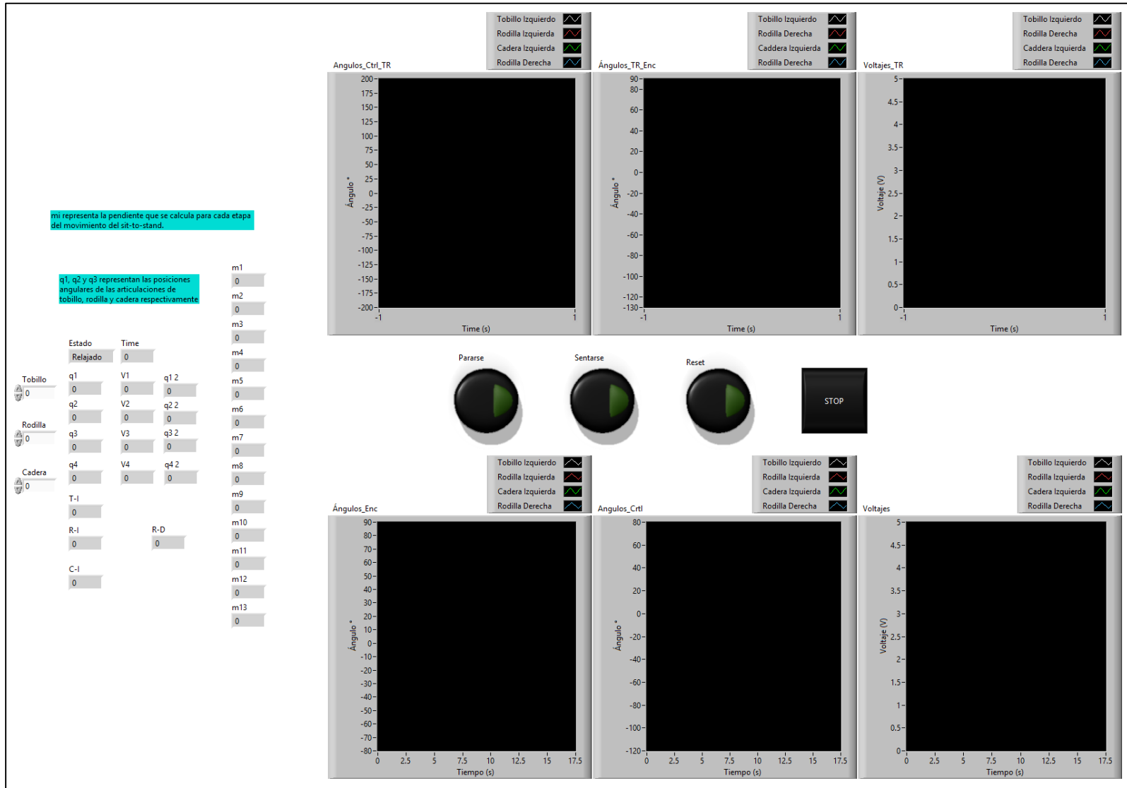
Figura D 10. Panel de control en el que se visualizan las trayectorias deseadas, los voltajes de control y las trayectorias desarrolladas por los miembros del exoesqueleto.
