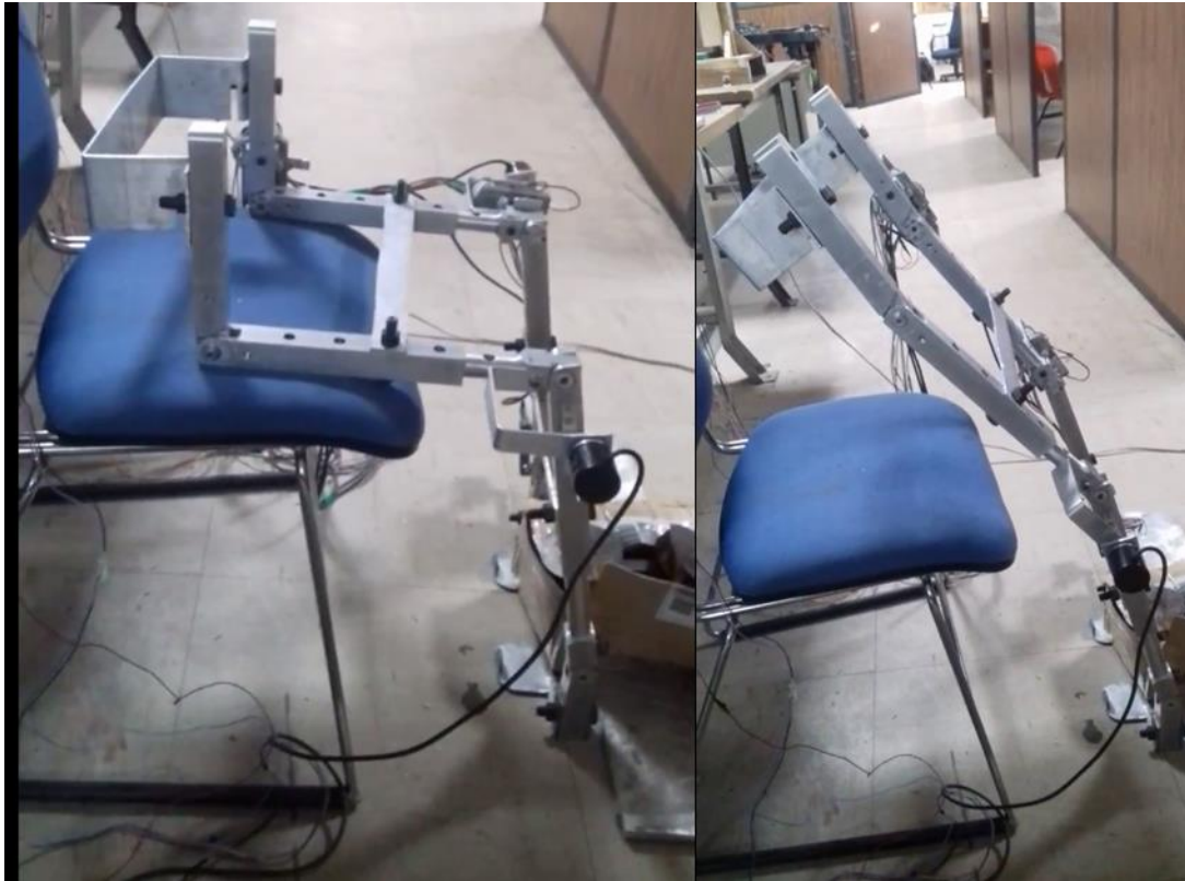
Figura 69. Instrumentación del exoesqueleto con tres actuadores y cuatro encoders.
