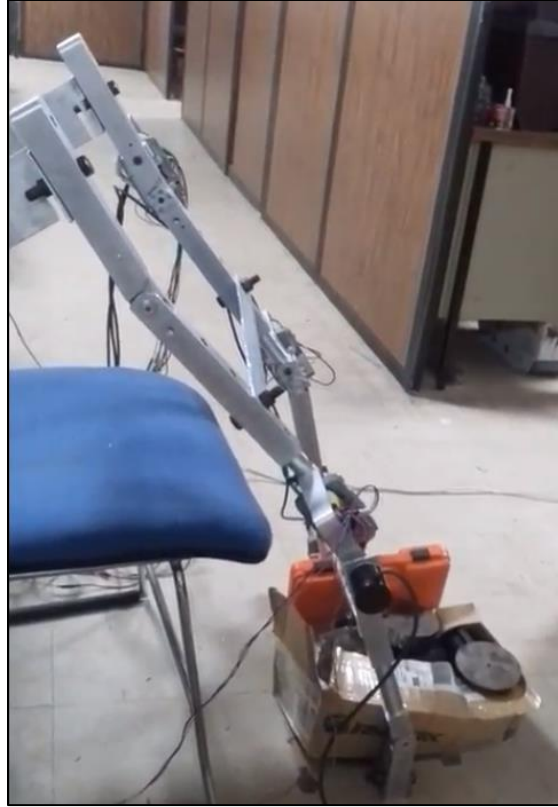
Figura 67. Postura que adopta el exoesqueleto completo, cuando es accionado por los cuatro actuadores y se le da la instrucción de levantarse y permanecer de pie.
