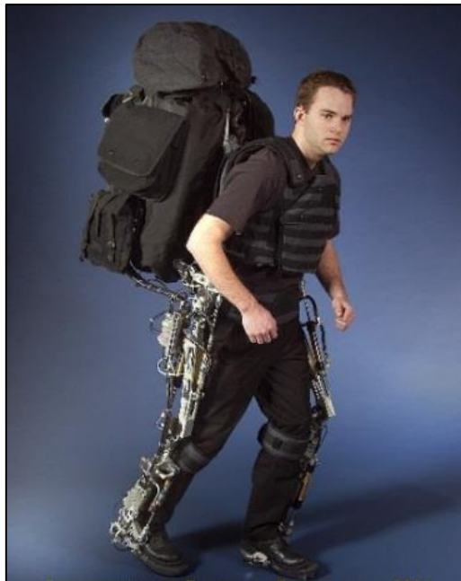
Figura 1. El Berkeley Lower Extremity Exoskeleton de 12 GDL cuenta con actuadores hidráulicos que incrementan la resistencia de su portador.
