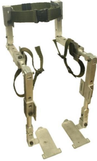
Fig. 1. Exoesqueleto de extremidades inferiores ajustable a las dimensiones del usuario.
