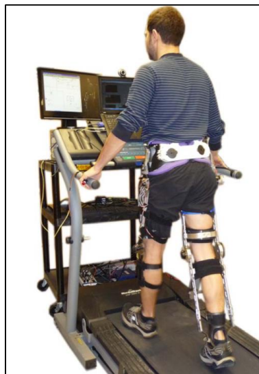
Figura 5. El exoesqueleto ANdROS de 1 GDL rehabilita la articulación de la rodilla.
