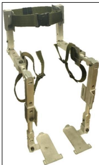
Figura 3. Exoesqueleto de extremidades inferiores de 6 GDL para la rehabilitación de extremidades inferiores de pacientes con hemiplejía.
