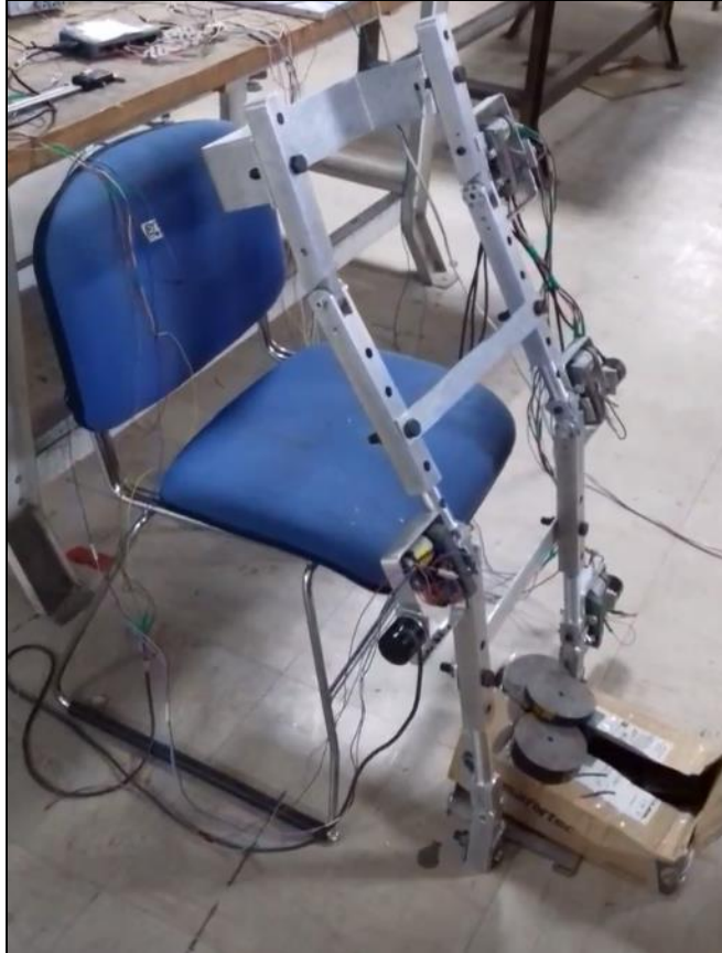
Figura 63. Exoesqueleto instrumentado completamente de la extremidad izquierda y en la rodilla de la extremidad derecha.
