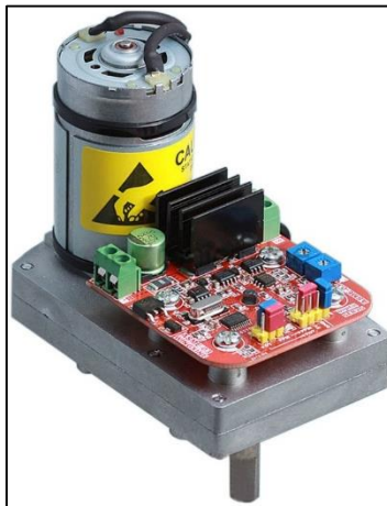
Figura 52. Servomotor WINGXINE ASME-03B con sentido de giro reversible. Presenta un control de posición por potenciómetro y 380 kg-cm de torque a 12 V.
