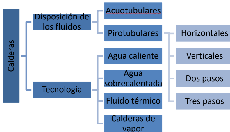
Figura 3. 6. Clasificación de las calderas (elaboración propia a partir de Uceda, 2012).
