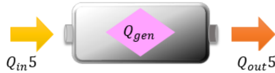
Figura 2.14 Esquema de comportamiento térmico del calentador auxiliar.
