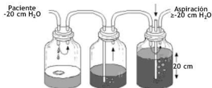
Figura 1.3-3. Sistema de tres botellas. El primer frasco hace de recolector, el segundo es el Bülau y el tercero regula la aspiración que se le transmite al paciente, dependiendo de la altura de la varilla sumergida.
