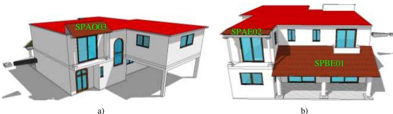
**Figura 4.7.** Sistemas pasivos de sombreado integrados en la fachada de la vivienda. a) Fachada principal orientada al Oeste, b) Fachada posterior orientada al Este.
