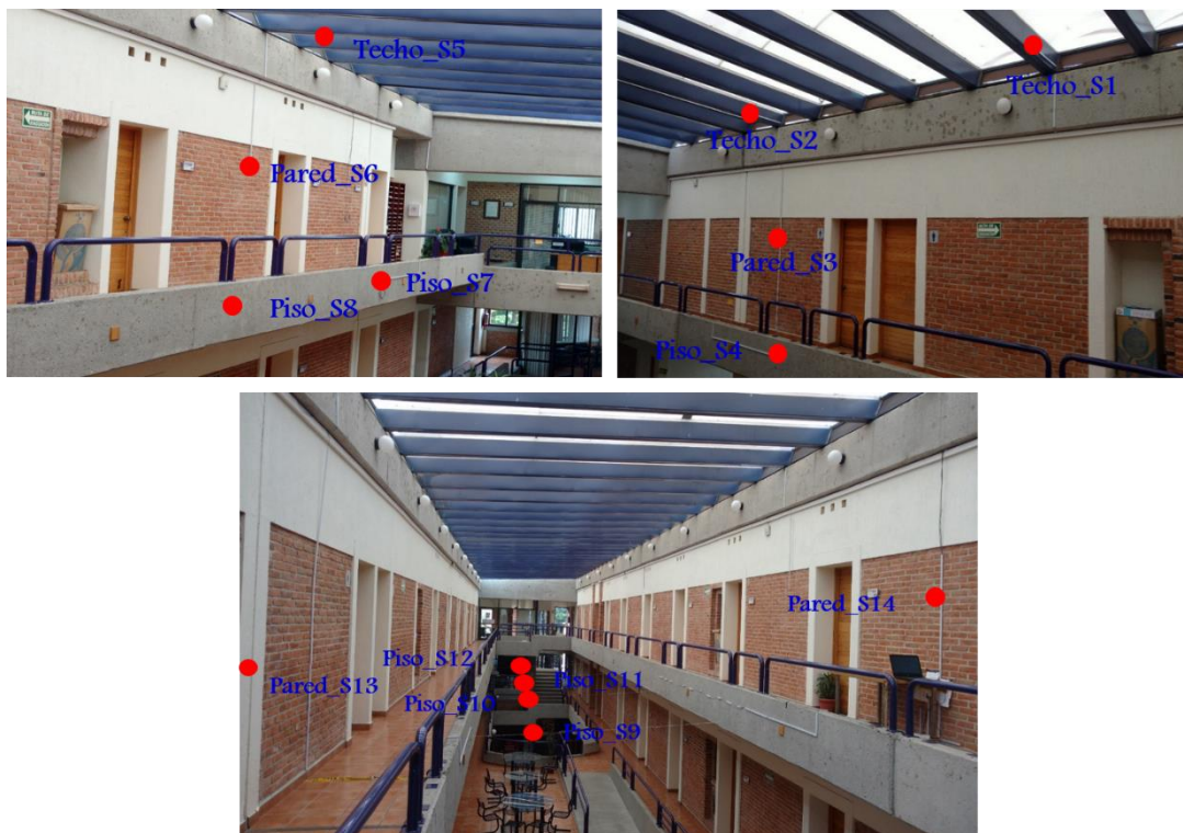
Figura 4.2. Distribución de los sensores en el interior del edificio.
