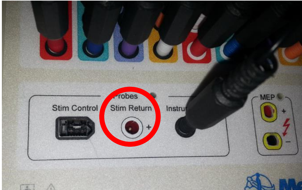
Figura 5.35 Ubicación del estimulador en la consola
