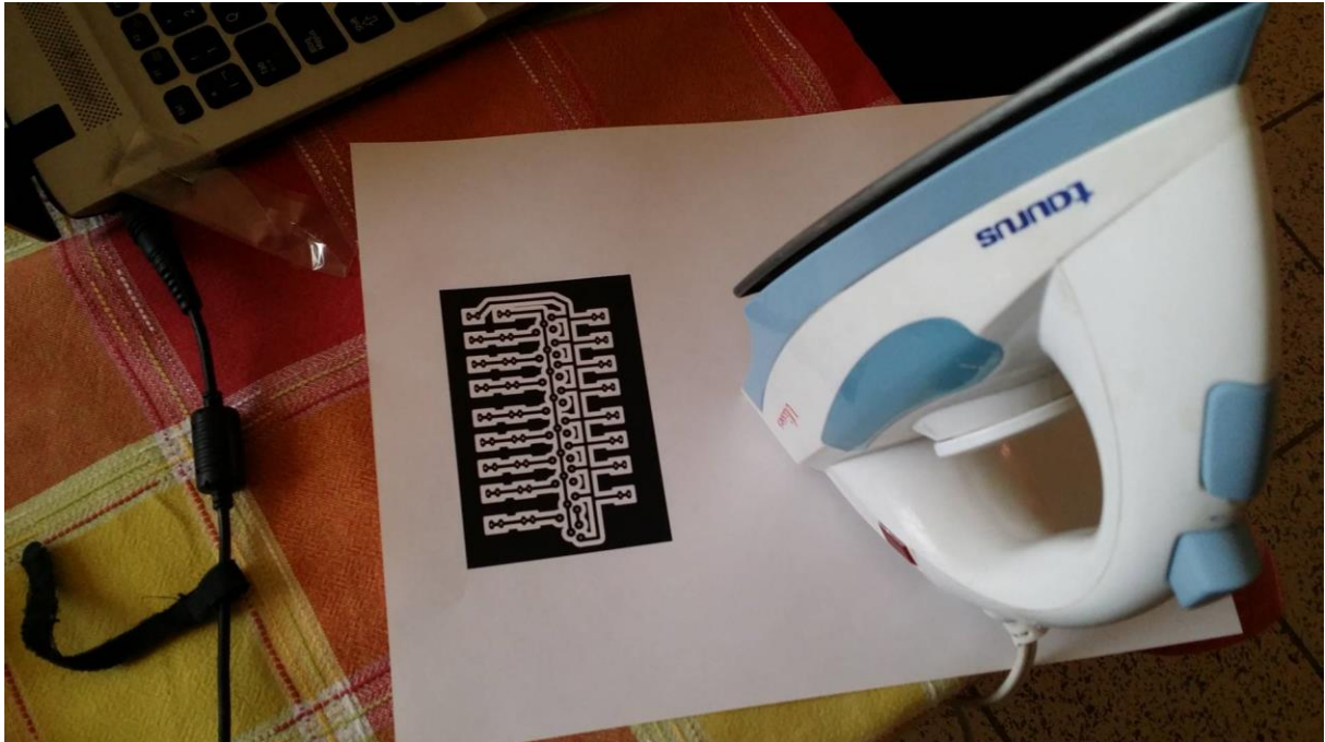
Figura 5.8 circuito impreso sobre hoja satinada
