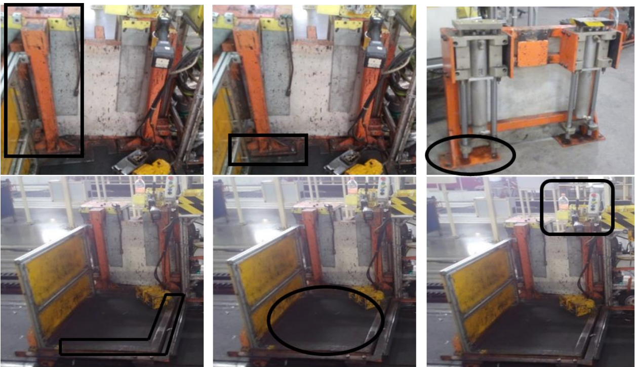
Figura 3-9 De izquierda a derecha y de arriba abajo: Portería, placas que unen plataforma con portería, placas que unen guarda con estructura angular, solera, tapete ergonómico y cajonera con botonera.
