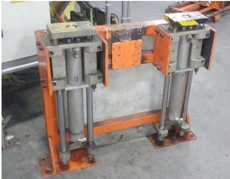
Figura 3-8 Guarda que sostiene a los cilindros guiados.
