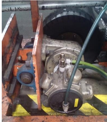
Figura 2.1-10 Motor neumático de doble sentido de giro.
