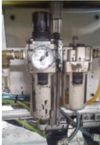
Figura 2.1-7 UNIDAD FRL (FILTRO-REGULADOR-LUBRICADOR) AW40-04CG.
