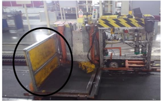
Figura 3-10 De izquierda a derecha: Placas que sostienen y unen a los cilindros guiados con la guarda, guarda frontal.
