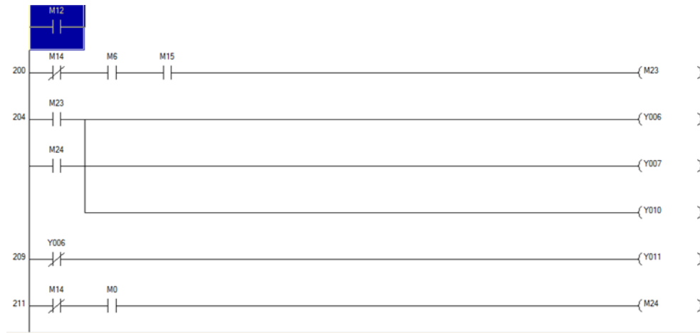
Figura 3-32 Arreglo en programación escalera del PLC.
