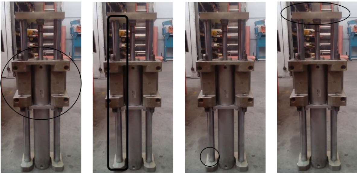
Figura 3-7 De izquierda a derecha son: el cuerpo, la carrera, el diámetro y el cabezal.
