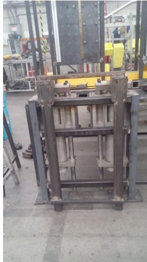
Figura 3-23 Guarda que sostiene a los cilindros guiados.
