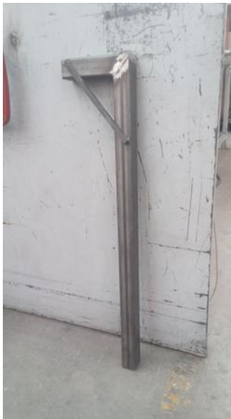
Figura 3-22 Portería que une el cabezal con la plataforma.
