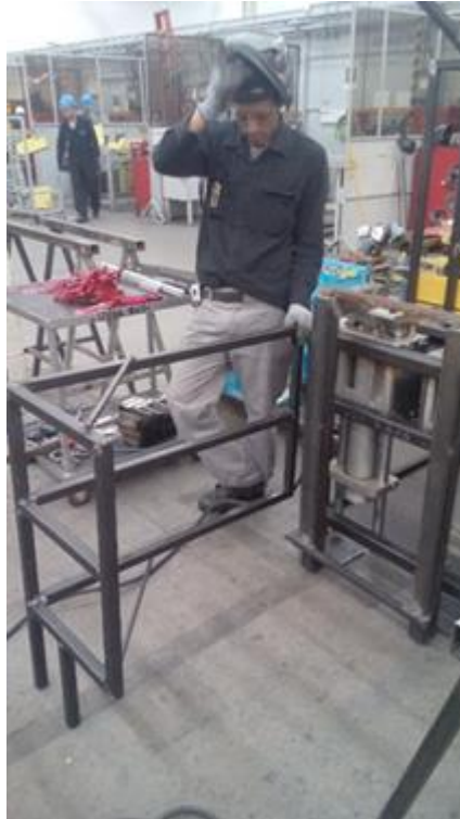
Figura 3-27 Técnico Javier Salas fabricando la guarda de seguridad.
