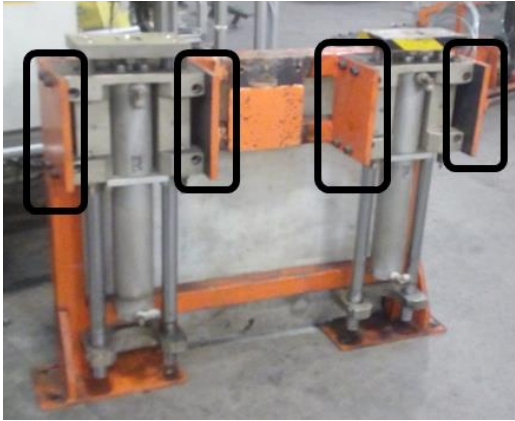
Figura 3-10 De izquierda a derecha: Placas que sostienen y unen a los cilindros guiados con la guarda, guarda frontal.
