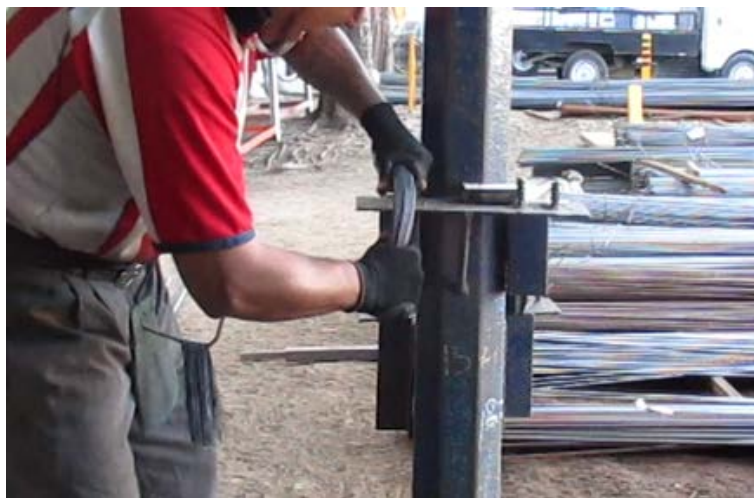
Figura 4.6: Doblado del alambre en forma de “U” usando una guía de doblado.
