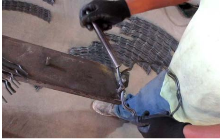
Figura 4.9: Doblado en forma de anillo del alambre calibre 8 troquelado.
