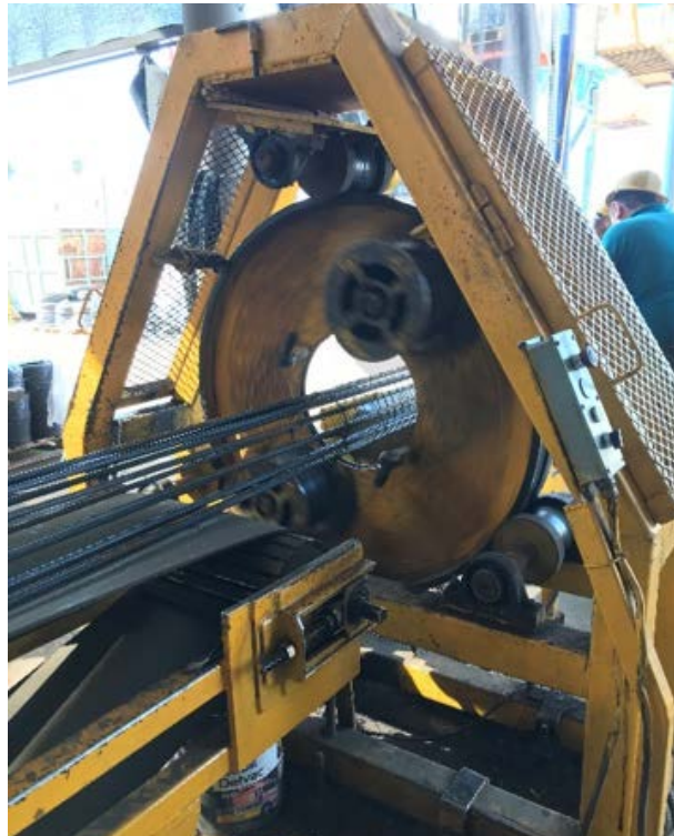
Figura 4.14: Zunchado realizado con maquina zunchadora.
