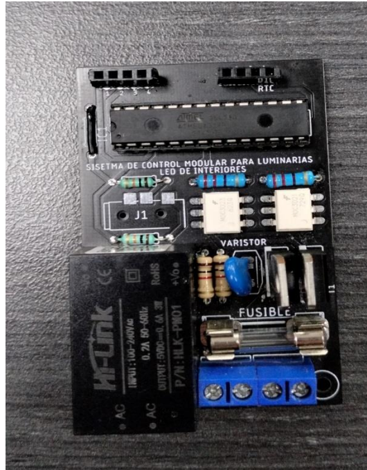
Figura 119. Sistema de control de luminarias que integra el circuito de potencia.
