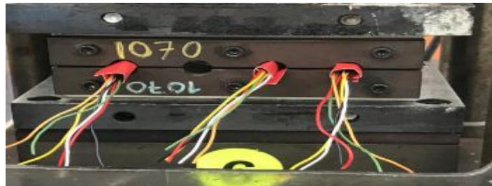
Figura 7. Molde colocado en la prensa durante el proceso de Moldeo.
