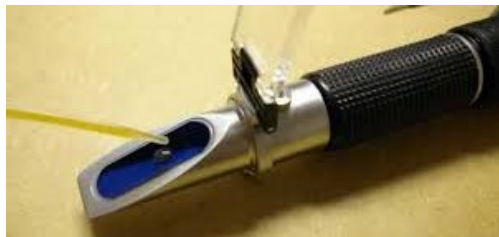
Figura 4.41: Uso de refractómetro para medir el volumen de alcohol.
