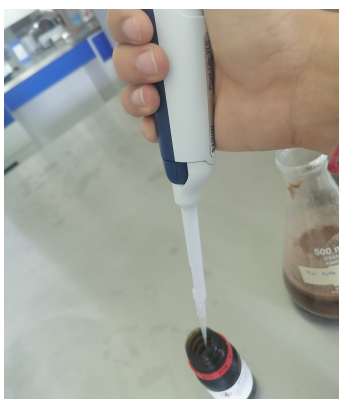
Figura 4.25: Toma de carga enzimática usando micropipeta.
