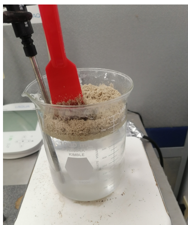
Figura 4.6: Incorporación de carga de bagazo al 4 % (p/v).
