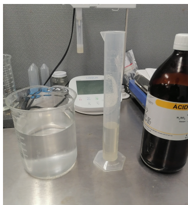
Figura 4.4: Preparación de solución con H_2SO_4 al 5% (v/v).
