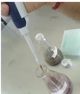
Figura 4.26: Incorporación de carga enzimática.
