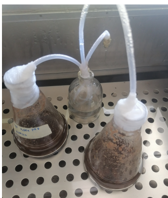
Figura 4.38: Acondicionamiento de medio anaerobio en proceso SFS.
