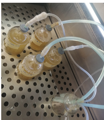
Figura 4.34: Acondicionamiento de medio anaerobio con trampa de aire.
