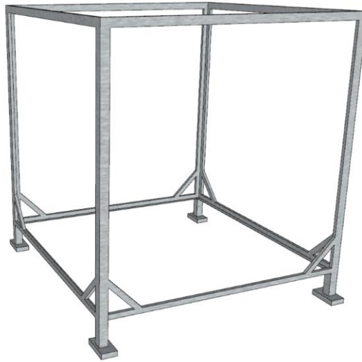
Figura 3.19 Estructura para soportar la losa.
