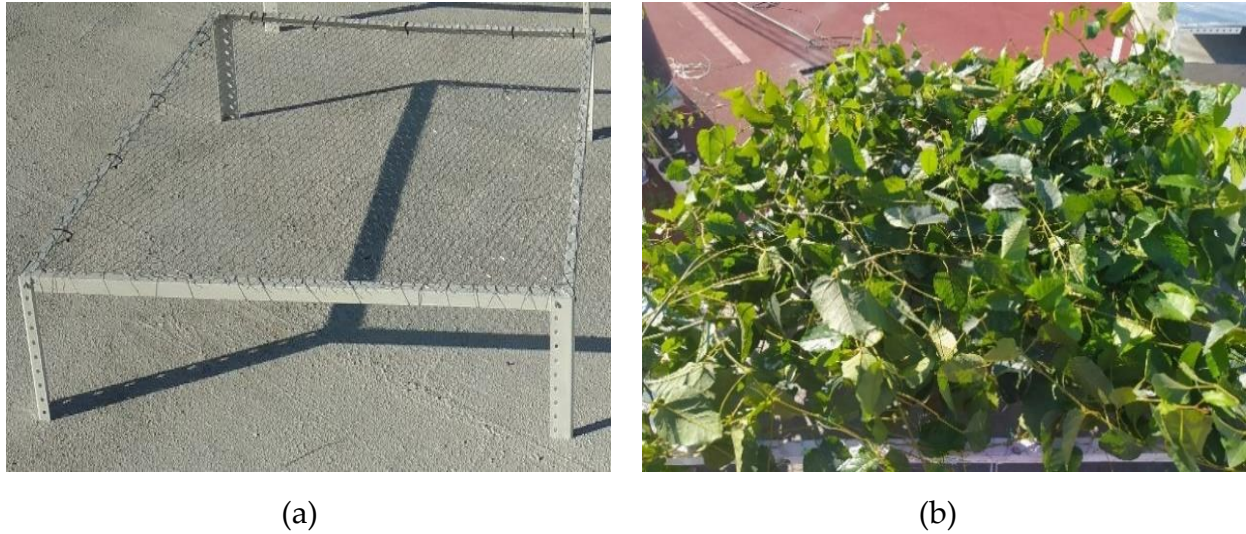
Figura 3.25 Componentes para formar el techo ventilado-verde: (a) base para soportar la vegetación, (b) vegetación.
