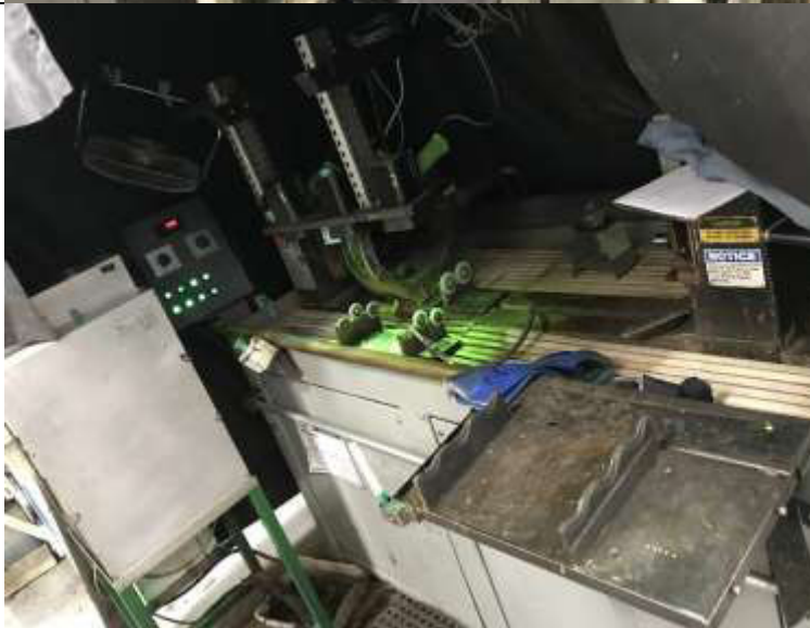
INSPECCION DE GRIETAS
