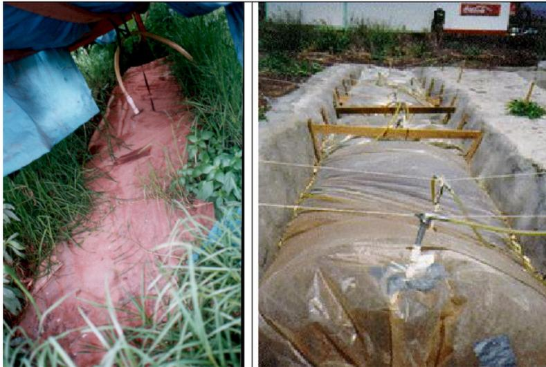
*Figura 2.4: biodigestores utilizados en las zonas lecheras de Michoacán<sup>16</sup>.*
