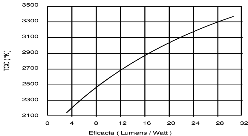
Figura 2.3 Eficacia para lámparas tipo PAR y R
