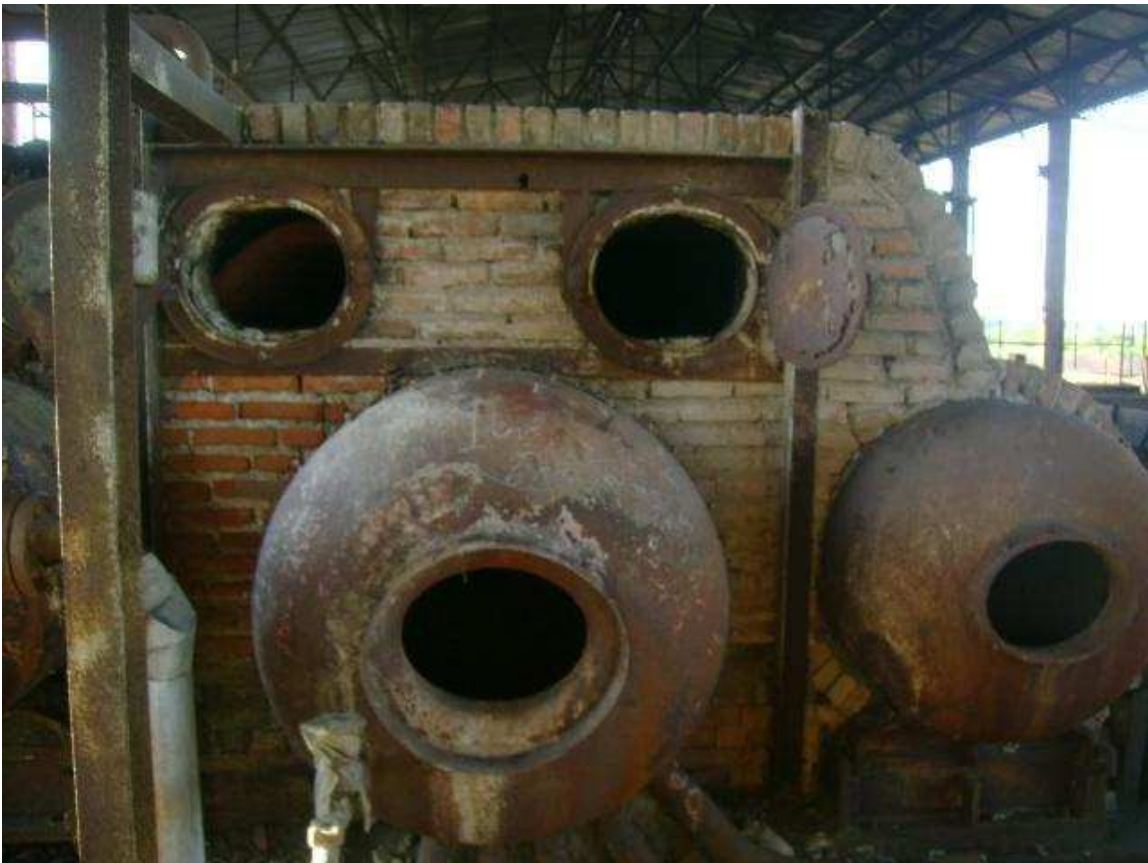
Figura 3.2 Caldera acuotubular típica (parte frontal)
