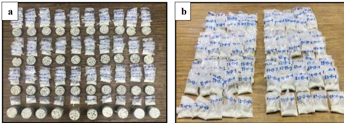
Figura 3.18 (a) Polvos y rodajas barrenadas y (b) Polvos de concreto cribado en tamiz No. 50.
