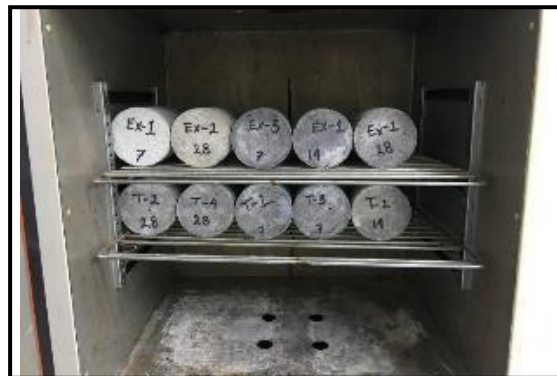
Figura 3.5 Secado de los cilindros en horno
