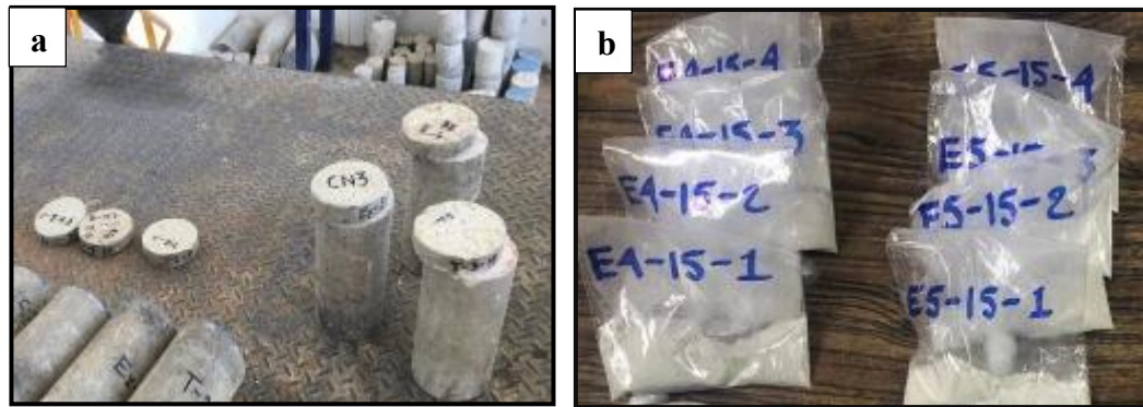
Figura 3.12 (a) Corte de rodajas previo a la inmersión (b) Pulverización de rodajas.
