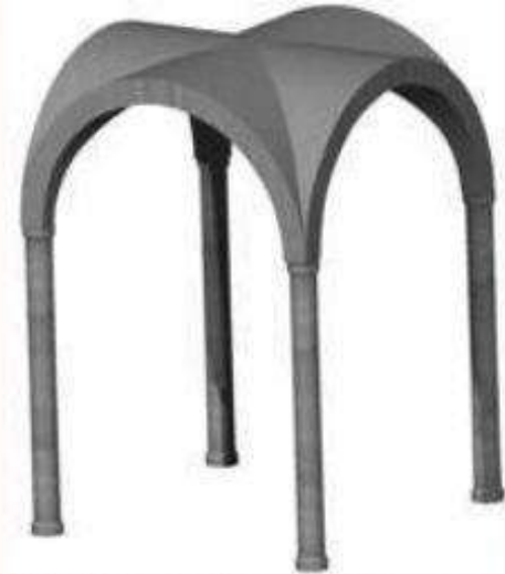
BÓVEDA DE ARISTA
