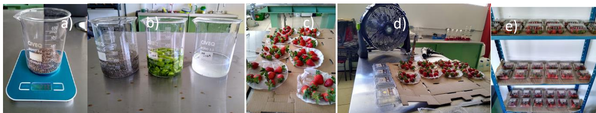
Ilustración 13. Tratamiento mucílagos. a) Pesado. b) Reposo de mucílagos de chíá, sábila y nopal. c) y d) Secado. e) Almacenamiento.
