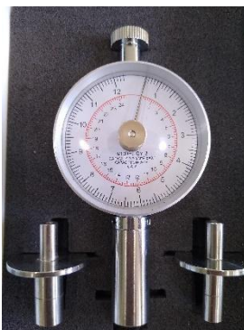
Ilustración 16. Penetrómetro análogo modelo GY-3* (DUAL) Doble Rango 0.5 – 12Kg/cm 2 y 1 – 24Kg/cm 2 .
