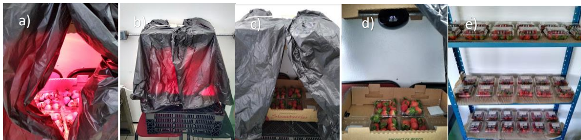
Ilustración 11. Tratamiento radiación infrarroja. a) y b) Cámara elaborada con cartón y bolsas negras. c) y d) Aplicación de dosis: 1, 2 y 3 minutos. e) Almacenamiento.
