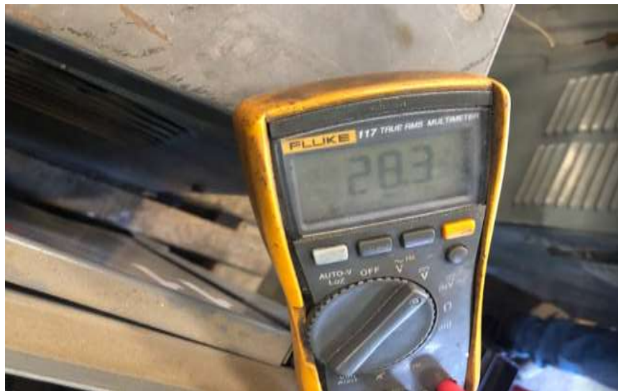
Figura 37. Disparo de voltaje hacia la compuerta (prueba física)
