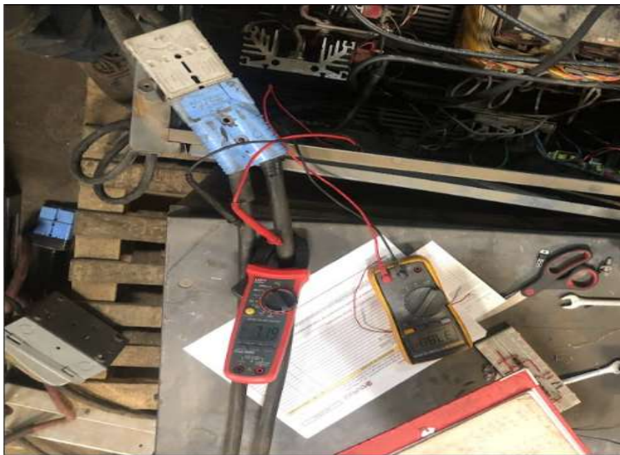
Figura 39. Obtención de suministro de corriente hacia la batería (prueba física)
