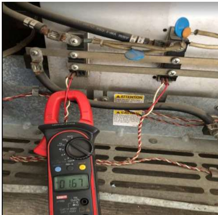
Figura 33. Medición de corriente mínima de disparo de SCR
