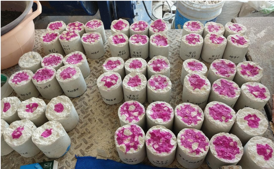
Figura 11. Probetas ensayadas a través de la prueba ácido-base con solución de fenolftaleína al 1%.
