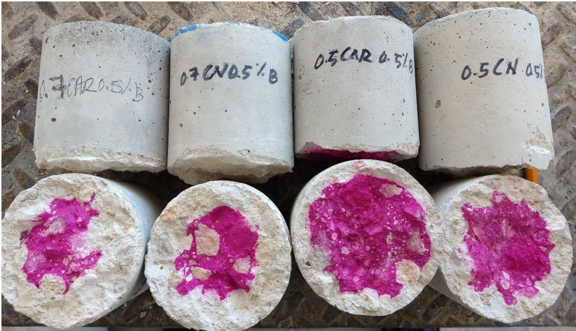
Figura 10. Avance del frente de carbonatación de las familias 0.7 CN, 0.7 CAR, 0.5 CN y 0.5 CAR con 0.5% de adición de bacteria.
