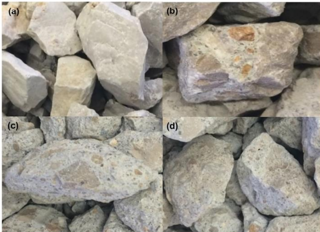
Figura 13. Morfología de los agregados. a-AGN, b-AGCR1, c-AGCR2 y d-AGCR3.
