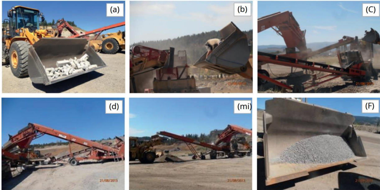
Figura 6. Proceso de trituración de los cilindros de concreto reciclado.
