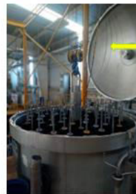
Uso de polipasto para sacar la carga
