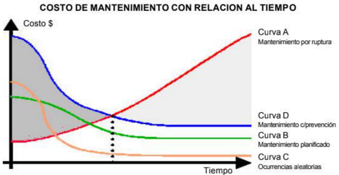
Ilustración 6 Curvas del costo del mantenimiento con relación al tiempo.
