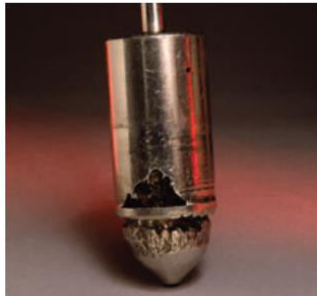
Ilustración 11 Aspecto típicos de daños por evaporación.
