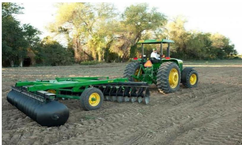
Fig. 23. Implementación de la rastra de discos para desmoronar los terrones presentes en la parcela (<https://www.deere.com.mx/es/equipo-de-labranza/rastras-de-discos/>)
