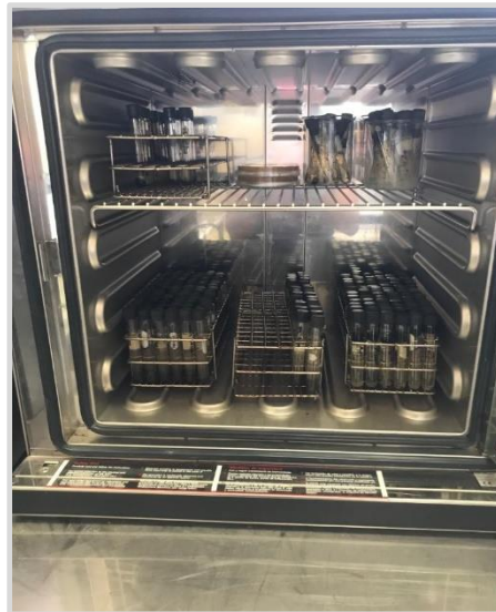
Figura 28 Tubos inoculados con Gt , LB y suelo contaminado a temperatura controlada a 55°C en la incubadora CO 2 -INCOMED-Memmert.
