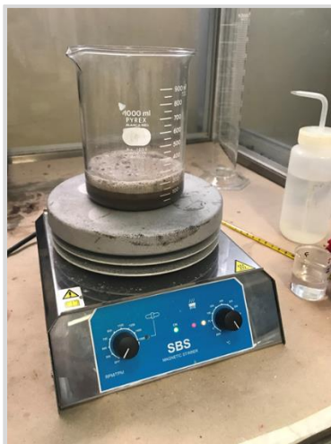
Figura 22 Reacción de la digestión de la materia orgánica en el Agitador magnético calefactado SBS
