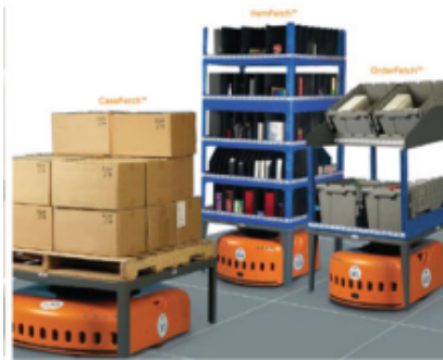
(a) Robot autónomo, configurado como montacargas, capaz de mover objetos pesados de una zona a otra, Sahni et al. (2019).
