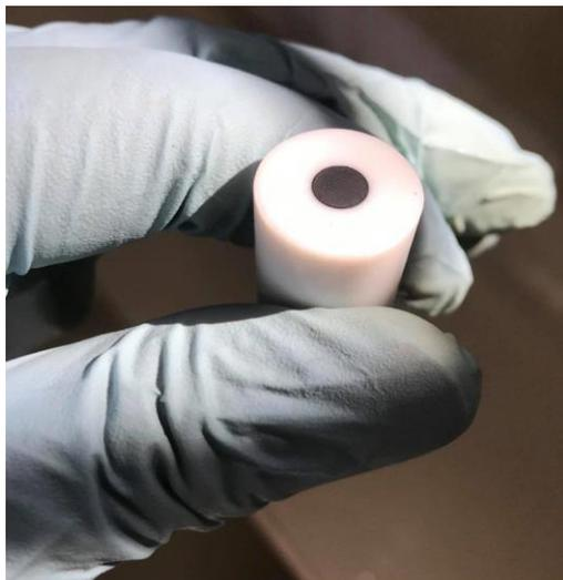
**Figura 14.** Electrodo de disco rotatorio modificado con tinta catalítica sobre su superficie.
