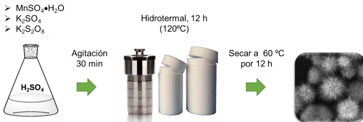
Figura 18. Esquema de síntesis de \text{MnO}_2 con morfología de flor de león de tamaño intermedio.
