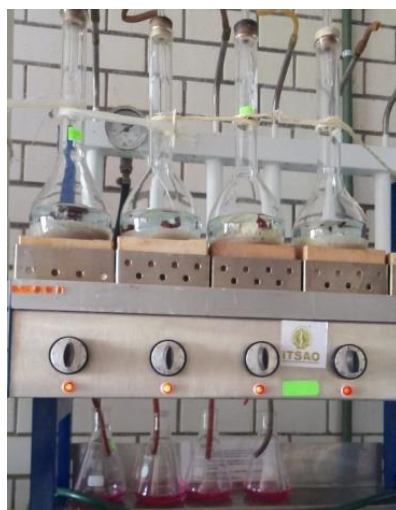
Figura 14. Determinación de proteína por el equipo Kjeldahl combinado
