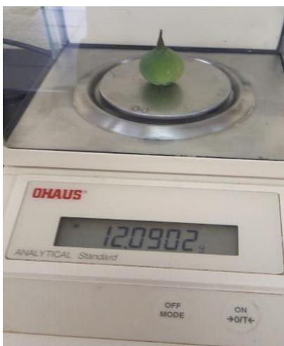
Figura 9. Pesado del fruto en balanza analítica modelo AS200, marca OHAUS
