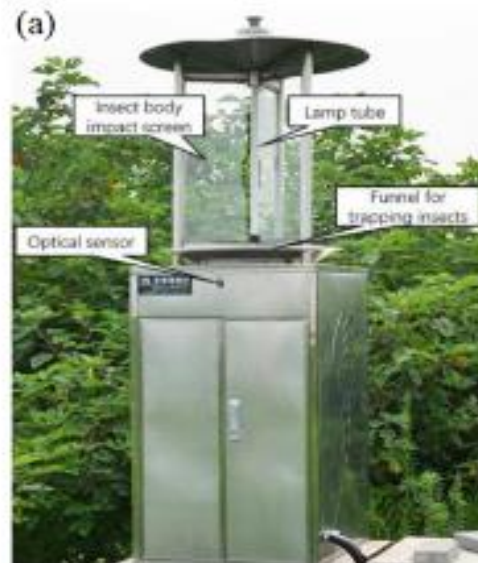
Figura 2.7 Dispositivo usado para la recolección de imágenes de insectos del dataset Pest24 (Q. J. Wang et al., 2020)
