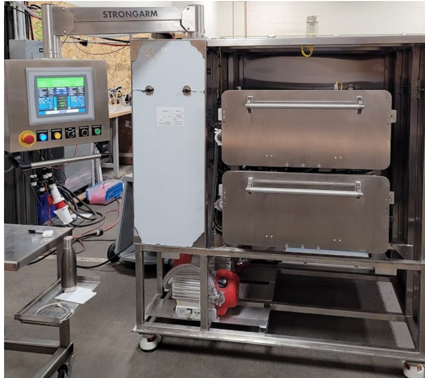
Figura 54, Foto Sistema de Prueba de Fuga, Frente
