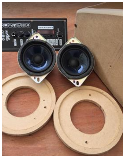
Figura 27 Presentación de los componentes de la caja acústica.
