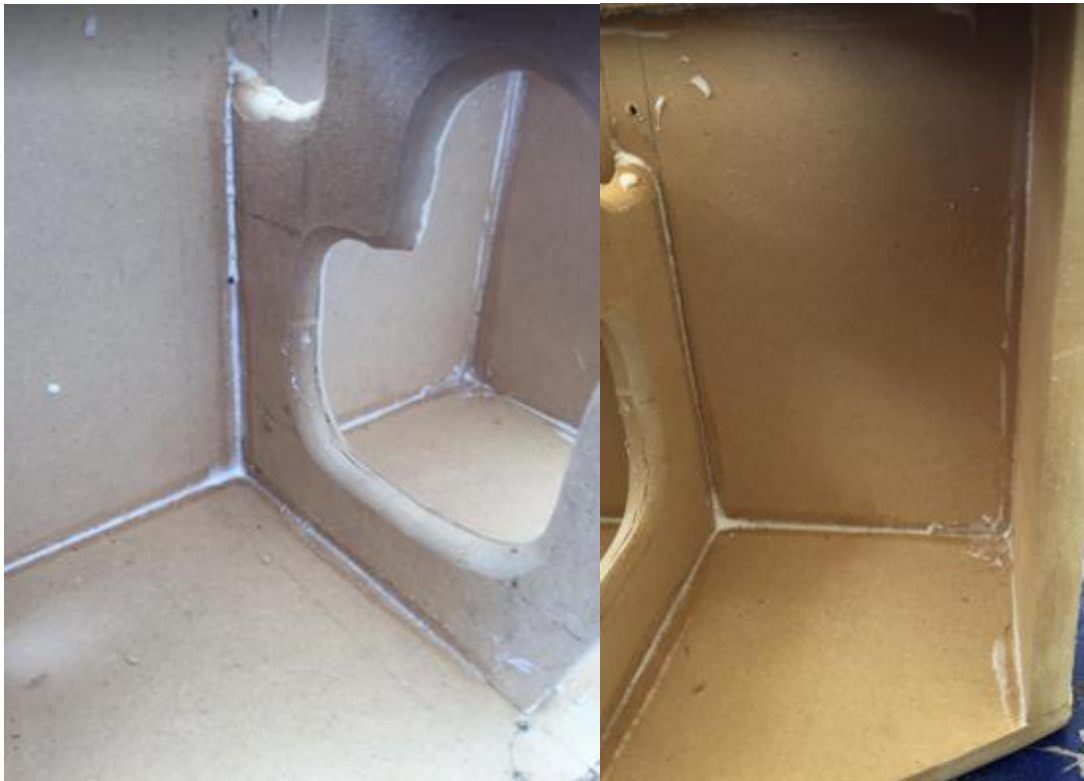
Figura 30 Proceso de fabricación de la estructura y refuerzos interiores de la caja acústica.
