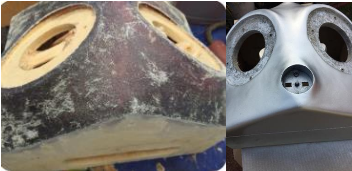
Figura 32 Proceso de elaboración de la caja acústica, con resina y fibra de vidrio, para obtener un recinto acústico, estructuralmente sólido.
