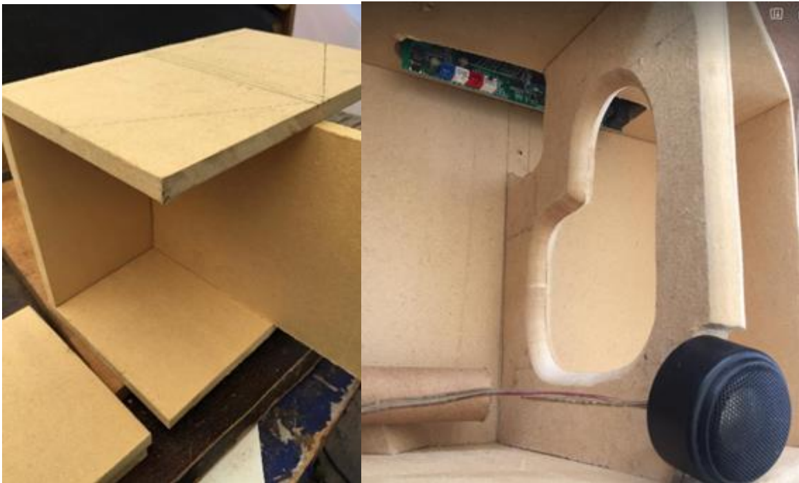
Figura 28 Imagen del ángulo horizontal, y refuerzo interno aplicado en la elaboración de la caja acústica.
