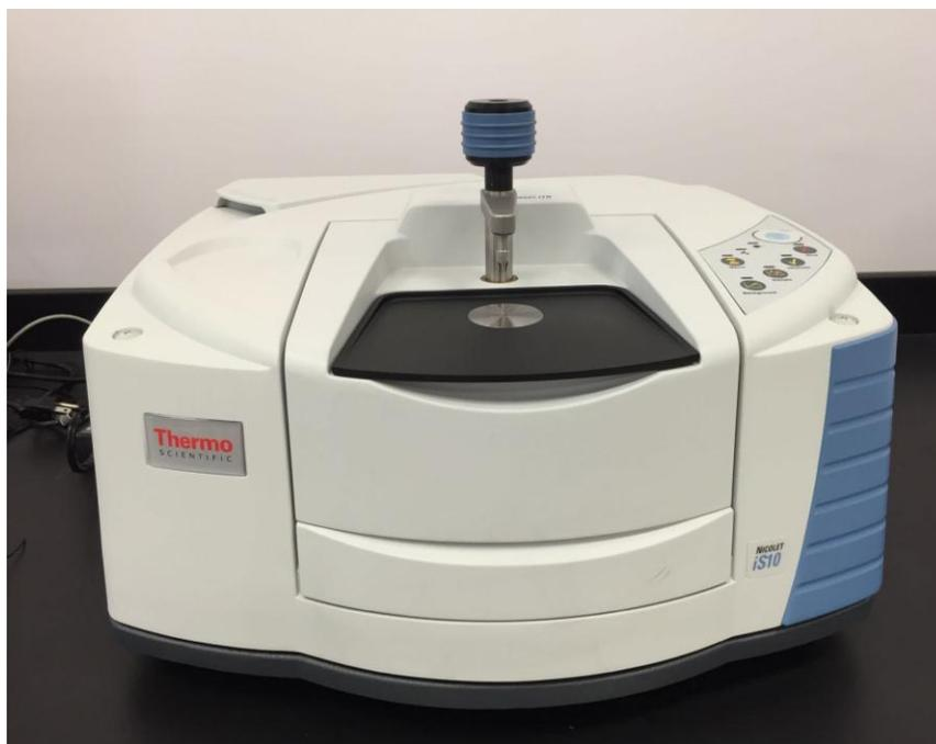
**Figura 5.** Equipo de Infrarrojo con transformadas de Fourier (FTIR).
