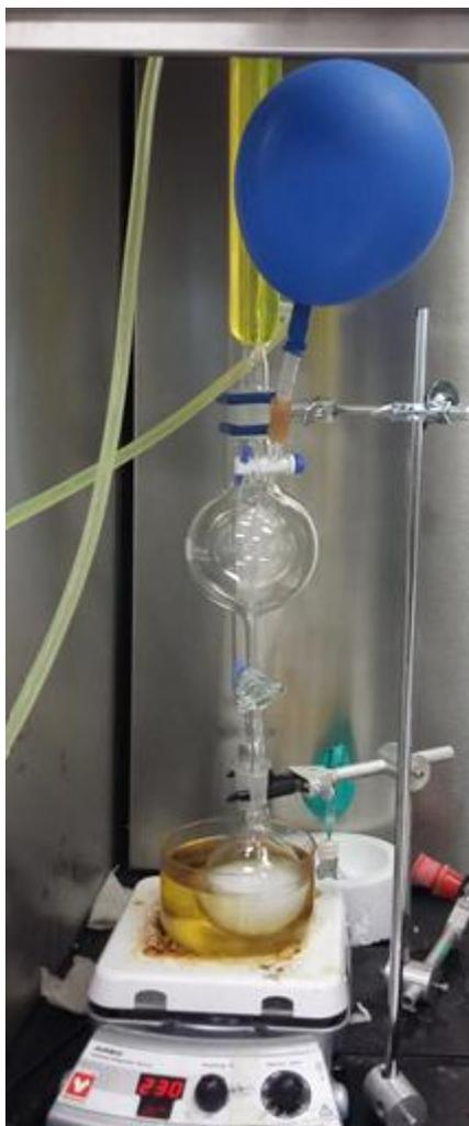
**Figura 8.** Sistema de secado de la  $\text{Et}_3\text{N}$  con cabeza de destilación.
