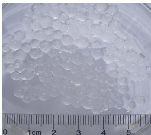
**Figura 3.** Esferas de carboximetil-celulosa usando epiclorohidrin
