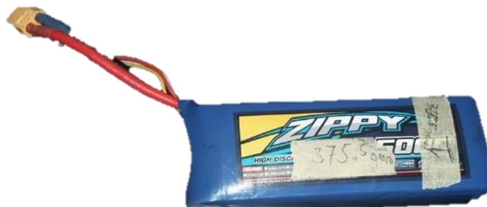
Figura 13. Batería de Litio
