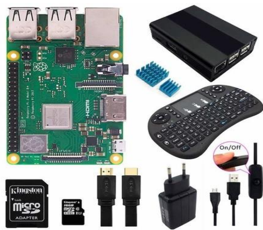
Figura 19.- Raspberry pi, junto con los periféricos mínimos para su funcionamiento [27].
