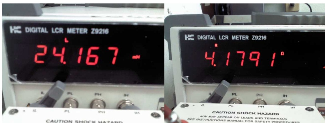
Fig. 2.22 Inductancia y resistencia obtenidos por el medidor RLC
