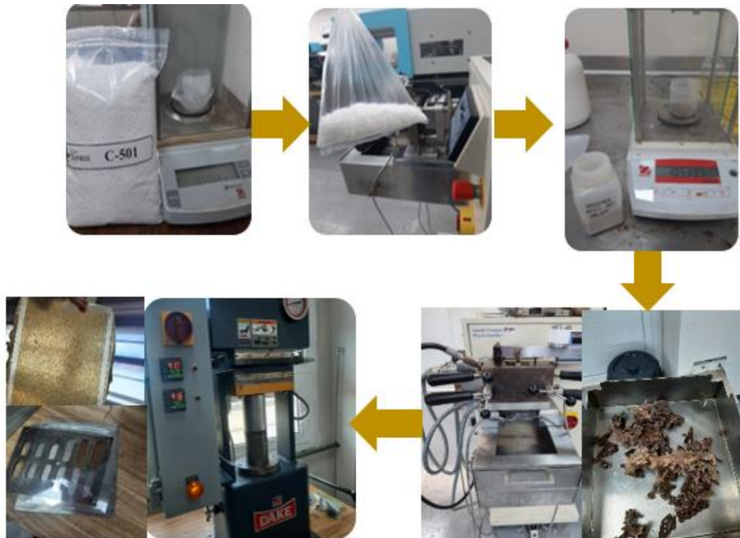
Figura 2.2 Procedimiento para la obtención de los compuestos SBS/PS.
