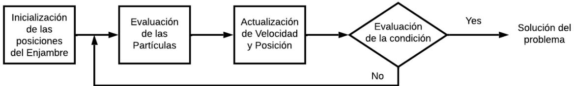
**Figura 5.4:** Esquema general del algoritmo PSO.
