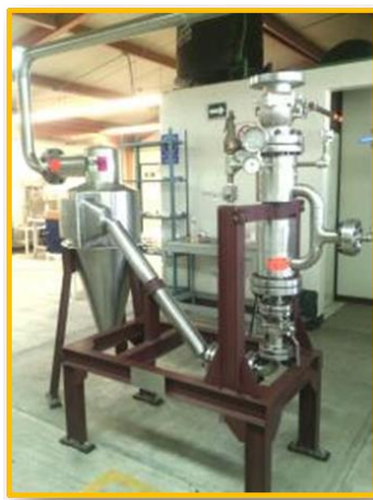
Figura 3. Equipo de explosión por vapor.
