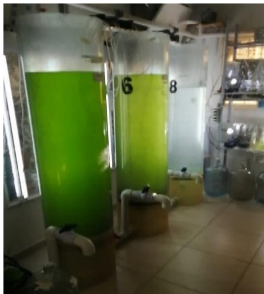
Figura 49. Incubación escalada en biorreactores de 200 L.
