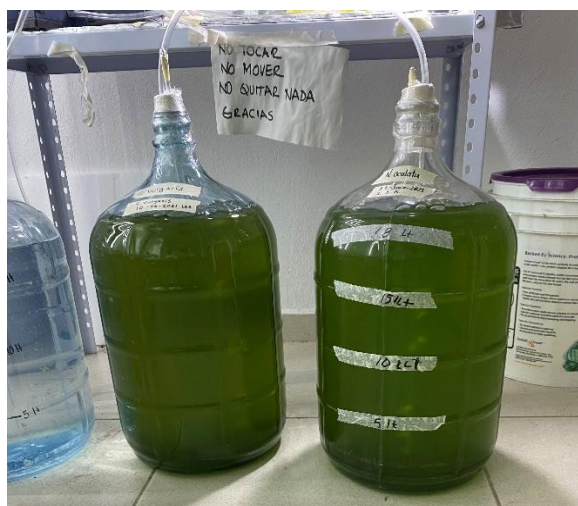
Figura 48. Incubación escalada en biorreactores de 20 L
