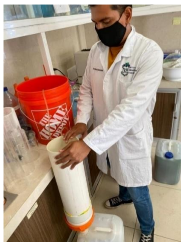
Figura 3. Filtrado del efluente de tilapia a través de la columna.
