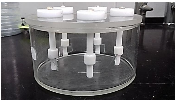
Figura 3.1 Montaje de los sustratos en los portasustratos de teflón en el recipiente cristizador de vidrio.
