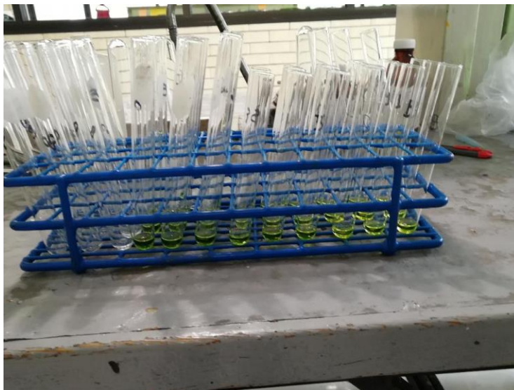
Fig. 14 Fenoles totales mediante Folin-Ciocalteu: preparación de la curva estándar usando Trolox como referencia
