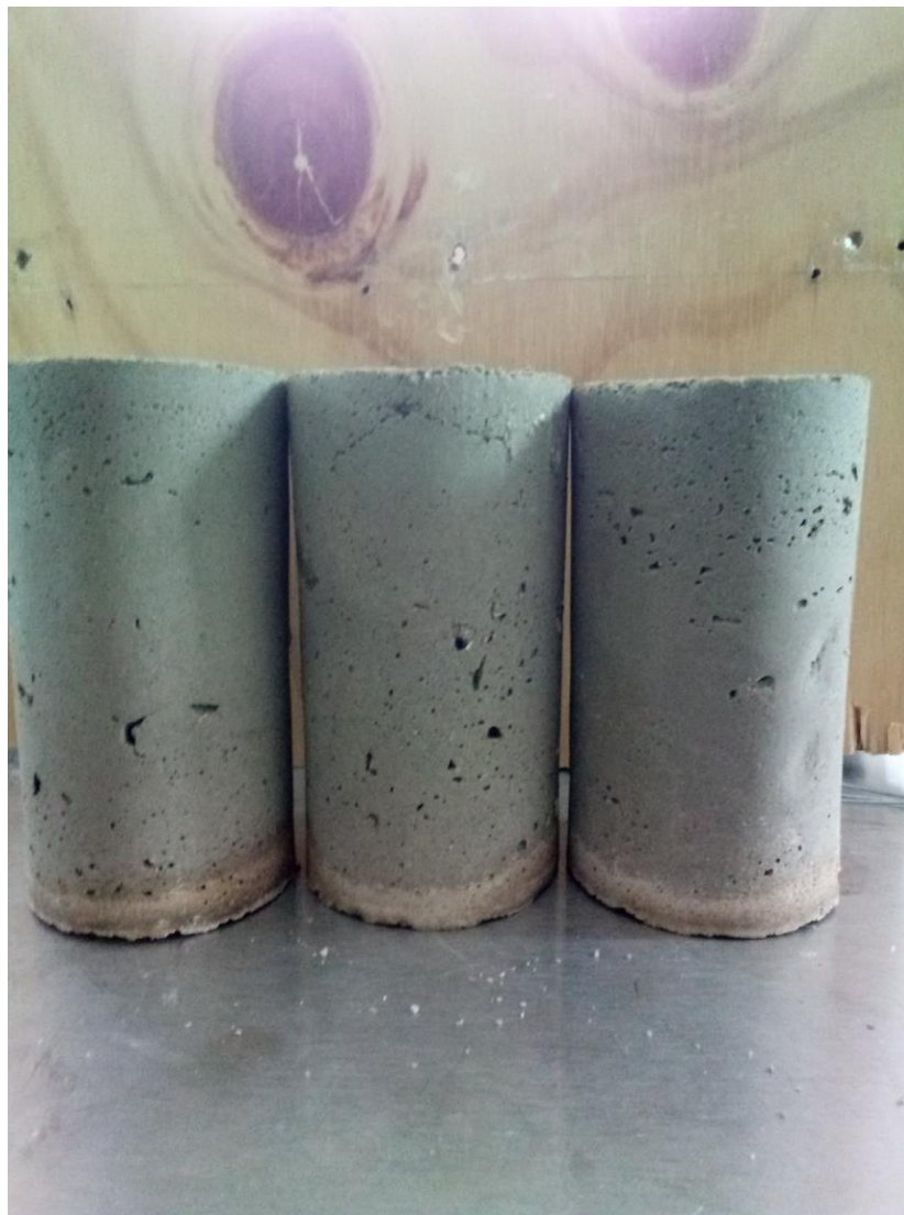
Figura 3.17 Cilindros para llevar a cabo la prueba de compresión.
