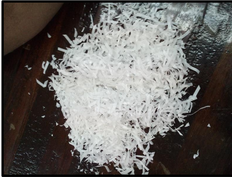
Figura 2.7 Polipropileno con una longitud de 2 a 3 cm.
