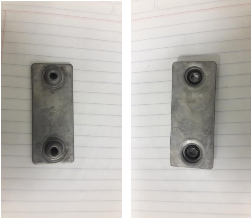
Imagen 20 Placa metálica con oxido después de tener un tratamiento de ultrasonido por 16 minutos
