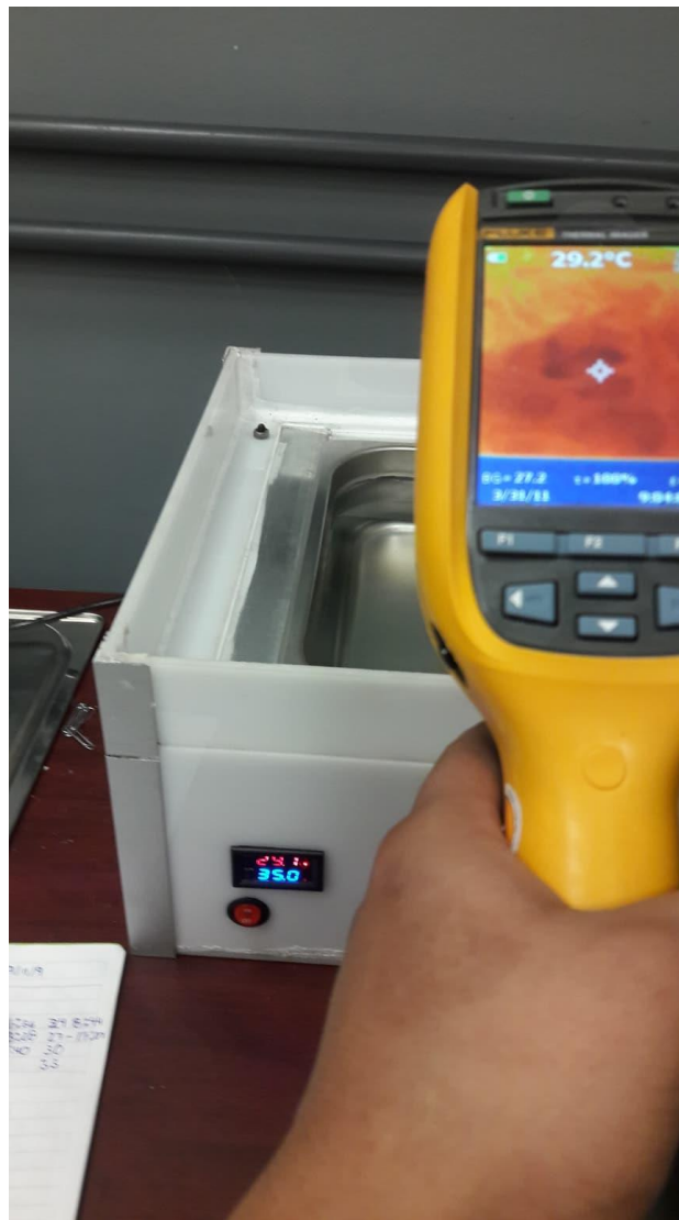
Imagen 13 Cámara termográfica y termostato con muy poca diferencia de temperatura
