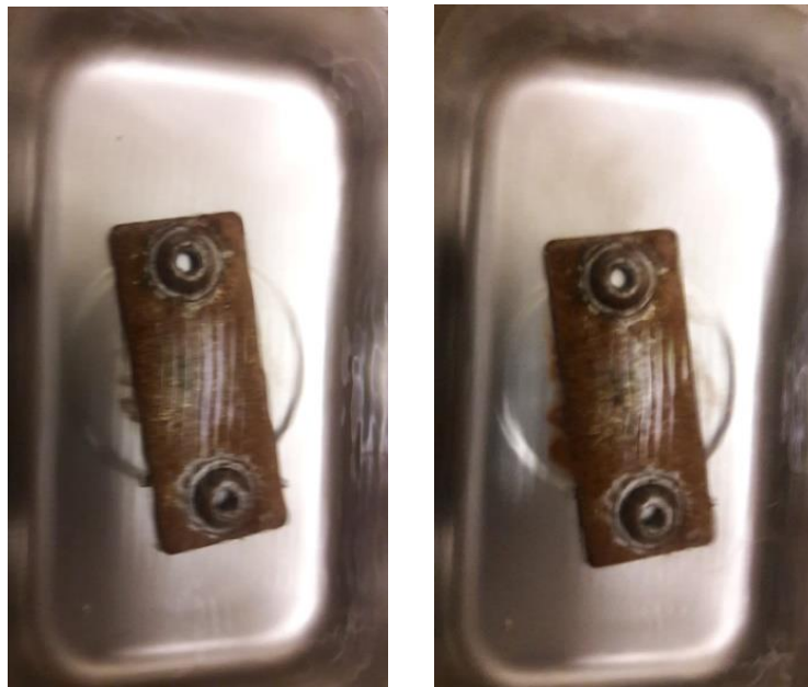
Imagen 17 Placa metálica con oxido sumergida en agua en el inserto de acero
