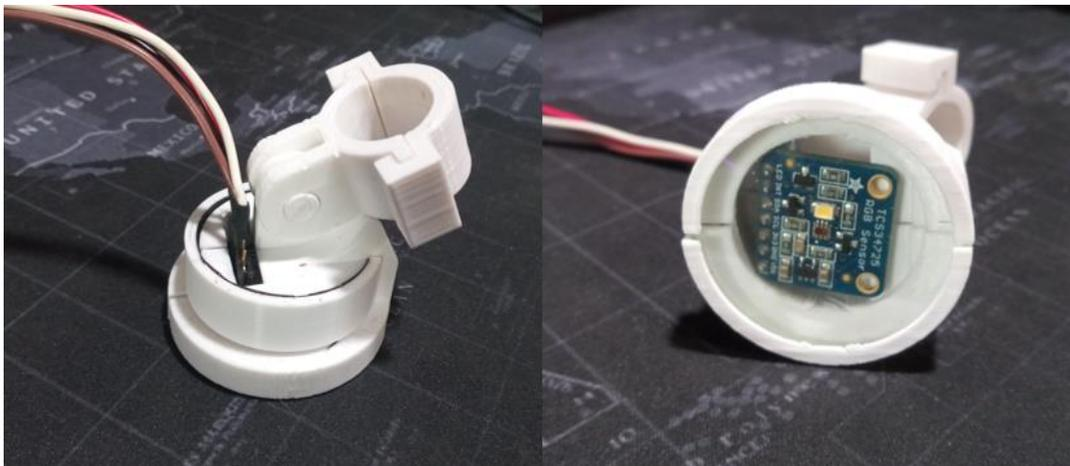
*Figura 35. Sensor TCS34725 en el ensamble.
